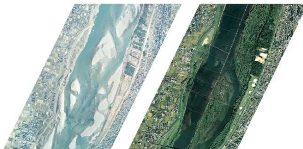
図 4 1973年(左)から2003年(右)にかけて河床低下に伴う堤外地の氾濫原の樹林化(木曽川中流域の例)
