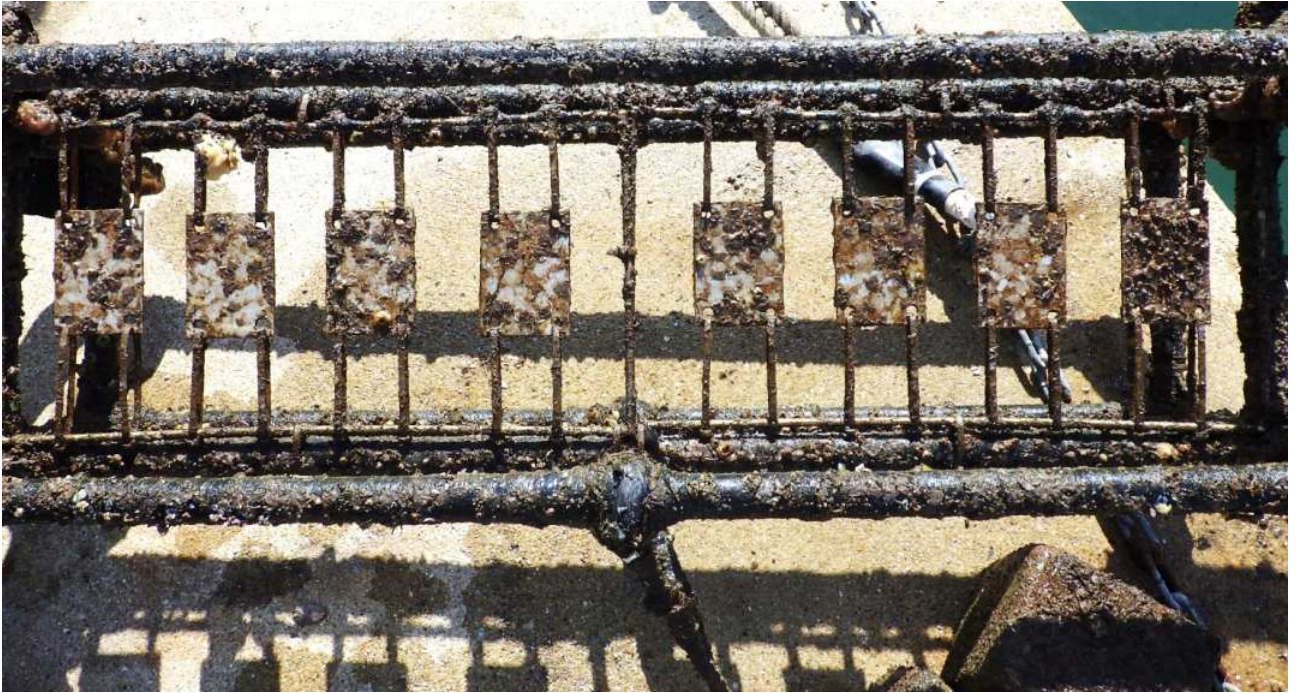
左からサンプル A : 1wt%, 5wt%, 10wt%, 0wt%, B : 1wt%, 5wt%, 10wt%, 塩ビ板
