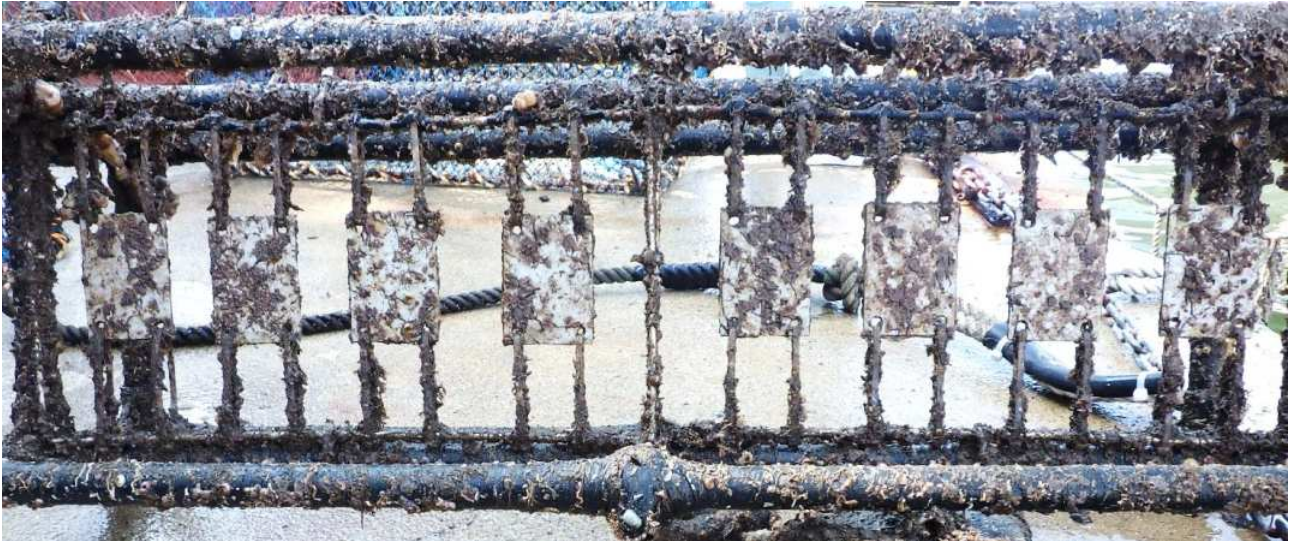
左からサンプル A : 1wt%, 5wt%, 10wt%, 0wt%, B : 1wt%, 5wt%, 10wt%, 塩ビ板
