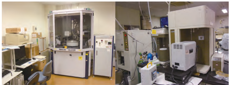
多孔性金属錯体の研究に用いるX線回折装置(左)とガス吸着装置(右)
