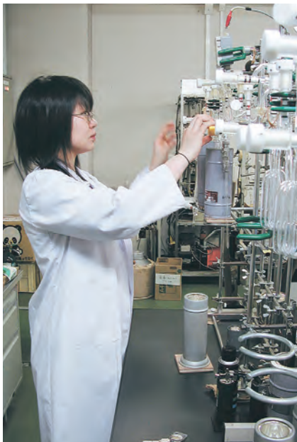
空気サンプルのCO 2 の同位体比を測定するため、空気からCO 2 を抽出します。-190℃の液体窒素で冷却することによってCO 2 を固化して集めます。
