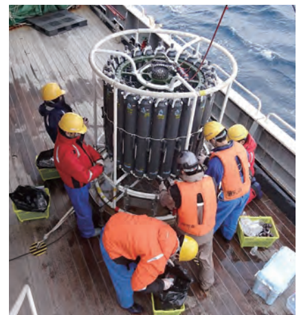
CTD-CMS 装置。海水温、塩分、水深の他、溶存酸素濃度、クロロフィル・溶存有機物の蛍光強度などの生物地球化学パラメーターも採水と同時にモニターすることが可能となっています。
