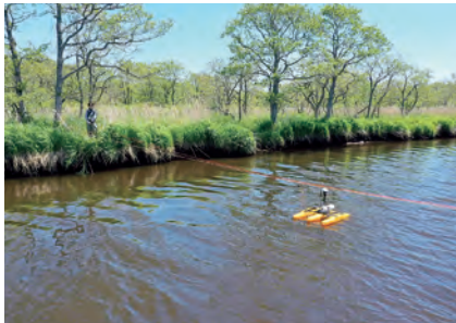
北海道東部の湿原河川におけるADCPを用いた河川流量観測
