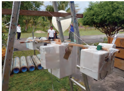
気球を用いた対流圏～成層圏の気球観測 ：1998年から熱帯各地で、オゾン、水蒸気、気温等の気球観測を実施し、熱帯大気の謎の解明に挑んでいます。雲粒子などのセンサーの開発もおこなっています。上のふたつの写真はインドネシアでの観測時のものです。上は、測器に取り付けたカメラで高度29kmから撮影した写真です。下には、放球前の気球と、雲粒子ゾンデ、オゾンゾンデ、水蒸気ゾンデが写っています。
