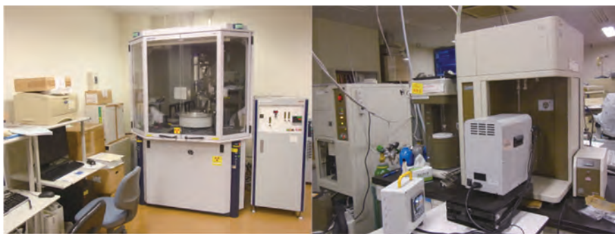
多孔性金属錯体の研究に用いるX線回折装置（左）とガス吸着装置（右）
