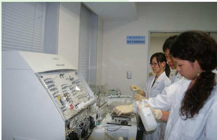
オートアナライザーを用いた栄養塩の測定
