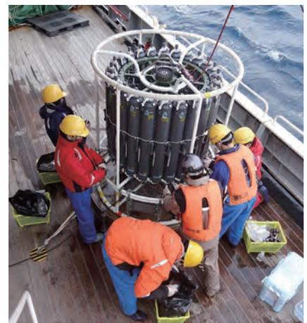
CTD-CMS 装置。海水温、塩分、水深の他、溶存酸素濃度、クロロフィル・溶解有機物の蛍光強度などの生物地球化学パラメーターも採水と同時にモニターすることが可能となっています。
