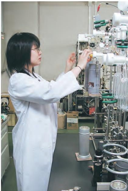
空気サンプルのCO<sub>2</sub>の同位体比を測定するため、空気からCO<sub>2</sub>を抽出します。-190℃の液体窒素で冷却することによってCO<sub>2</sub>を固化して集めます。
