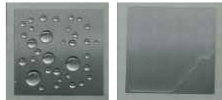
ステンレス板にコーティングした酸化チタン薄膜の超親水化
