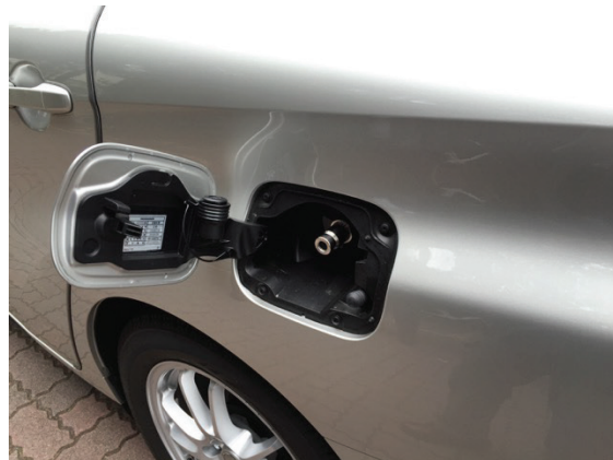
図4 MIRAIの水素ガス充填口。現在は高圧ガス取扱免許が必要でセルフ注入できないが、将来は規制緩和される見込みです。さらに、この規格が世界標準になるかもしれません。
