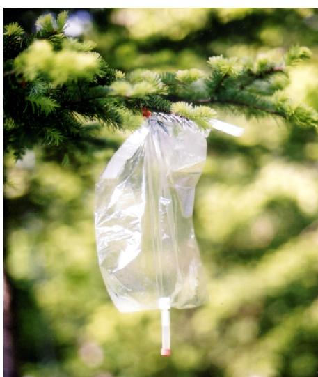
図 2: 目標となる枝にビニール袋をかけ密封し、 ^{13}\text{CO}_2 を添加する。
