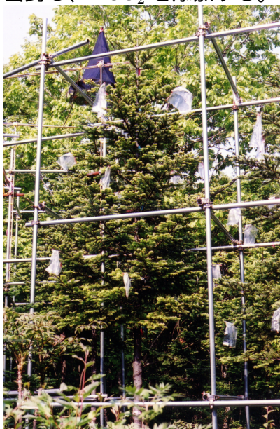
図 2: 目標となる枝にビニール袋をかけ密封し、 ^{13}\text{CO}_2 を添加する。
