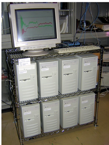
図 4: PC8 台を繋いだクラスタ型計算機
